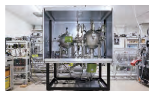
新たな校正室と高い精度を誇る真空校正装置（中央）
